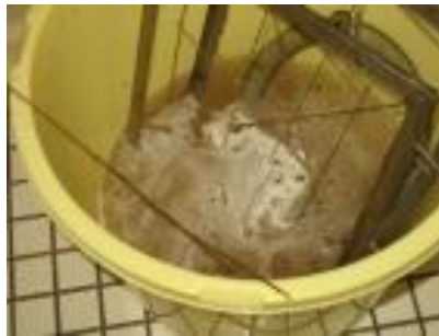
スーパークリーナーを温水で溶かす (30L 漬け物容器) で溶かすと すぐに油が溶けます
